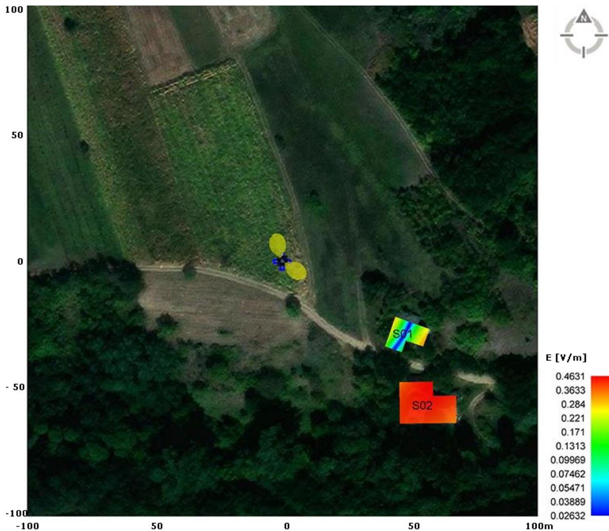
Slika 6.7. Rezultati proračuna jačine električnog polja u objektima kada sistem GSM900 operatera Telekom Srbija radi maksimalnim kapacitetom
